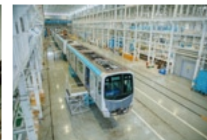
検修場の2階からは工場エリアを一望できる。真下には2～3ヵ月かけて行われる検査のために、細かく分解された車体が
