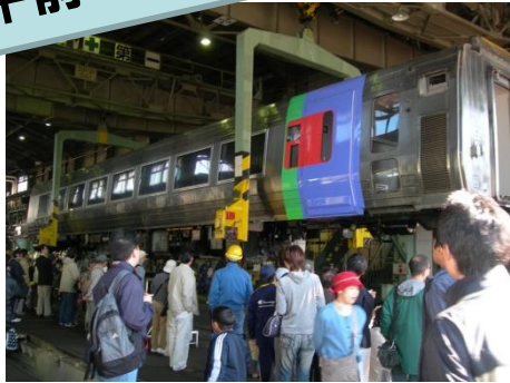
車両台車入れ作業
