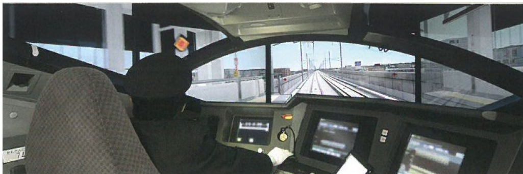
図1 運転シミュレータの例（実車を完全に再現した運転室）
