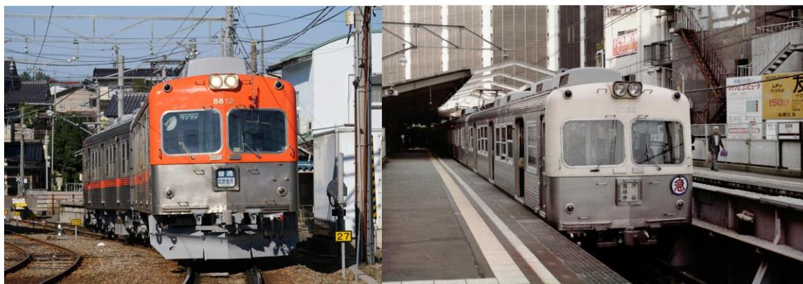
浅野川線 8802 編成(写真左)は、京王電鉄井の頭線で運行していた昭和 38 年製造の京王 3000 系(写真右)を譲り受けたものです。客室扉が片開きである初期型編成は全国でも浅野川線でのみ運行している貴重な車両です。
