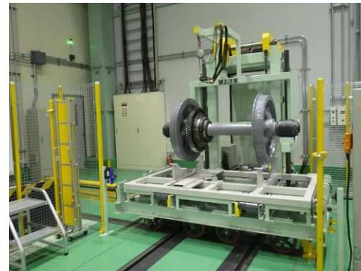
移載・搬送装置で輪軸を運搬
