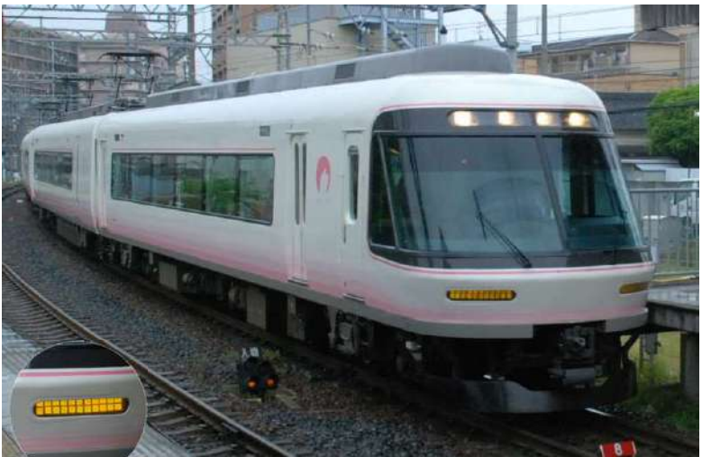
端が2段の前面下部標識灯(第二編成)
