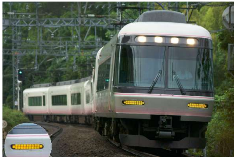
端が1段の前面下部標識灯(第一編成)
