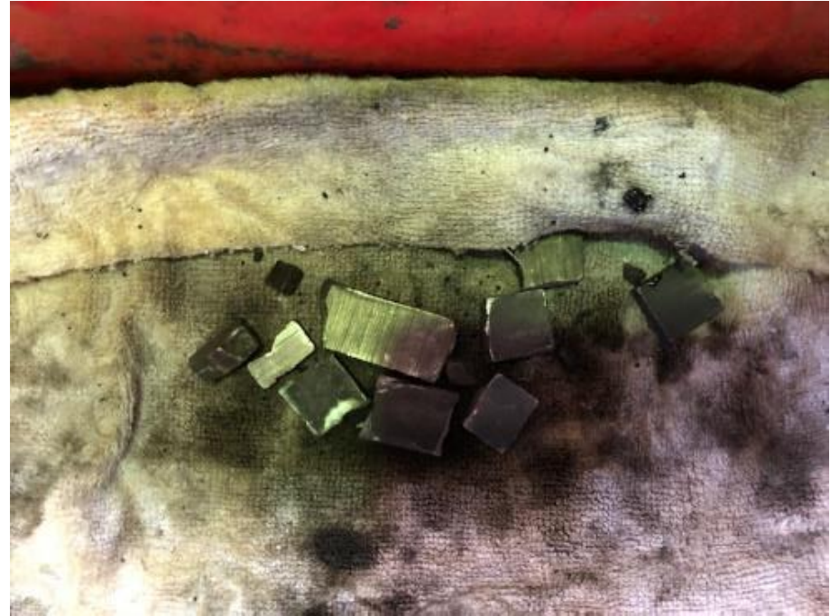
損傷したピストリングの破片
