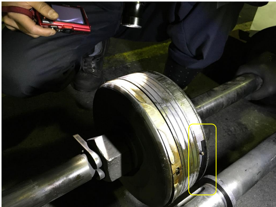
損傷したピストンリング
