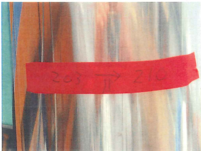
マーキングテープに測定値をメモ (例では、押し勝手 203mm⇒引き勝手 210mm ∴遊び量 7mm)
