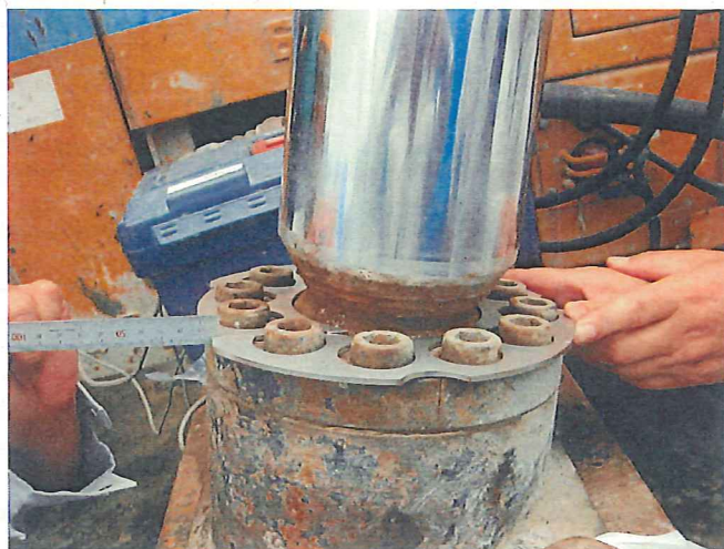
専用ゲージAタイプの使用状況 (写真は右側シリンダ後側の押し勝手状態を測定中)
