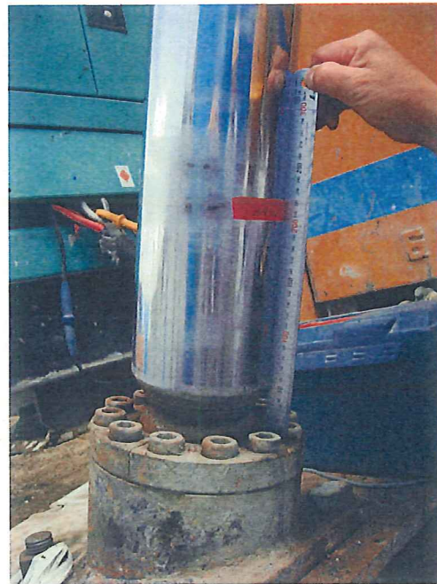
右側シリンダ前側の測定中 (押し勝手・引き勝手の各測定値平均)
