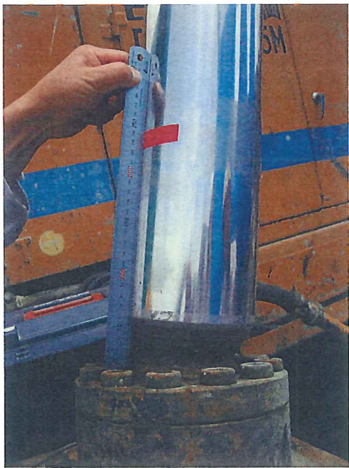
右側シリンダ後側の測定中 (押し勝手・引き勝手の各測定値平均)
