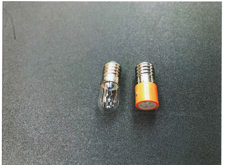
④ウインチモードランプ 左=電球 右=LED
