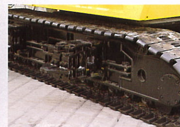
▲クローラ伸縮作業時
