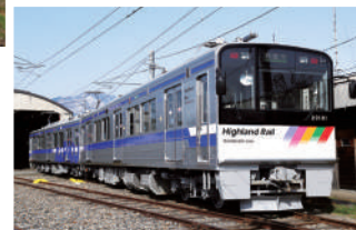
元東武20000系を転用改造したアルピコ交通の車両
