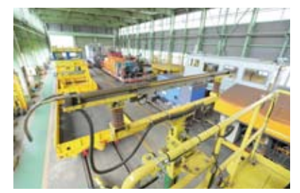
地下トンネルの点検に用いる特殊車を保管するトロッコ庫。「レール削正車」「多頭タンパー車」「電気高所作業台車」など珍しい車両がずらりと並びます。
