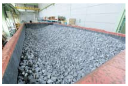
南北線の線路には、運行による衝撃を緩和するために「砕石」が敷かれています。「砕石散布車」の中には砕石が大量に積み込まれていました。
