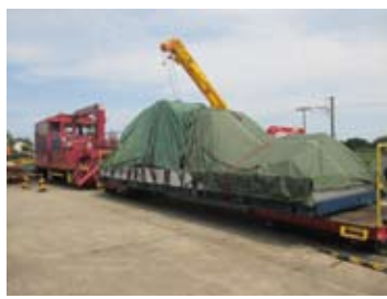
1 エスカレーター工事に使用する大型の部品は地下から運ぶため、富沢車両基地からモーターカーで台原駅まで運搬します。
