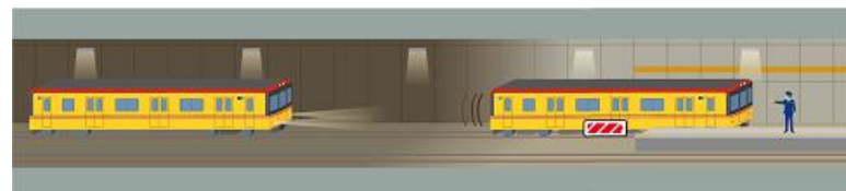
▲非常用走行バッテリー搭載車（イメージ）
