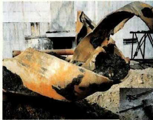
掘り出されたH鋼杭▲
