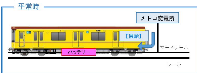
車両に搭載する非常用バッテリーイメージ
