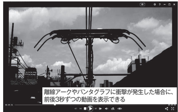
図2 異常検出時のパンタグラフ動画
