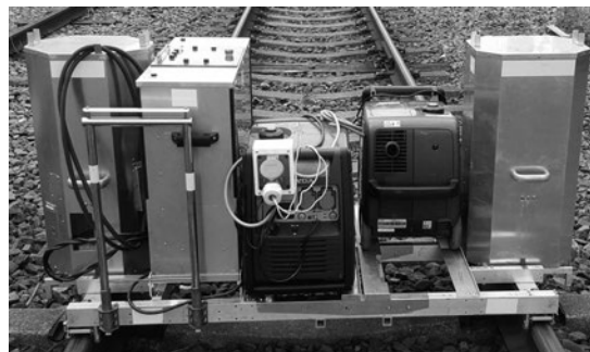
図7 新幹線軌道用多頭式ボルト緊解機（試作機）
