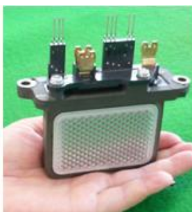
図 2 両面冷却型フル SiC モジュール
