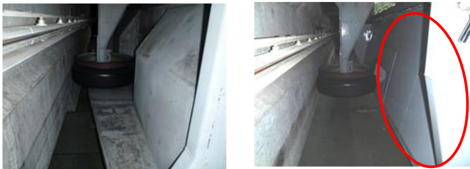
車両スカートの改良（右：改良後）
