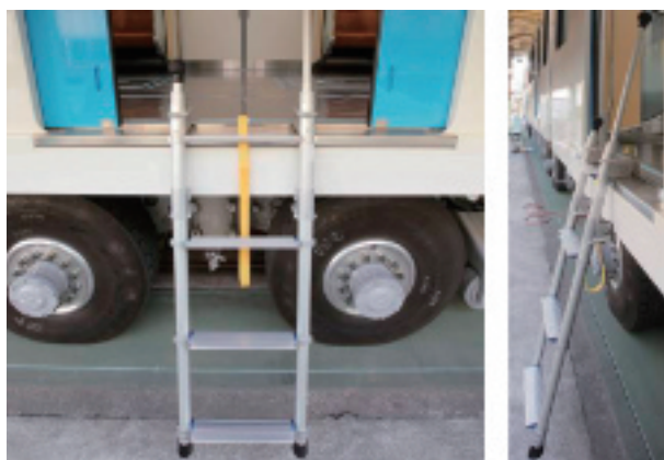
客室内の非常梯子
