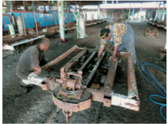
写真-37 FSCラウトカ工場内のサトウキビ貨車修理所では、作業員2人が修理をしていた。(2014年2月24日)
