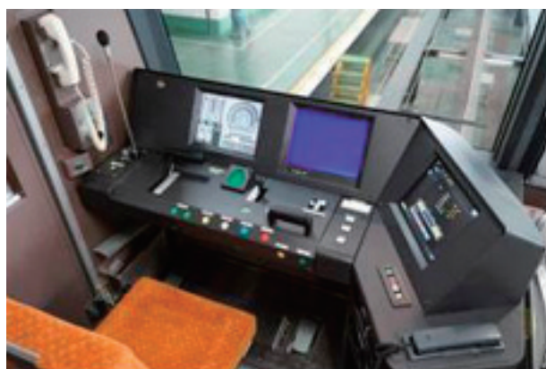
写真-7 運転台に設置した車上検査装置
