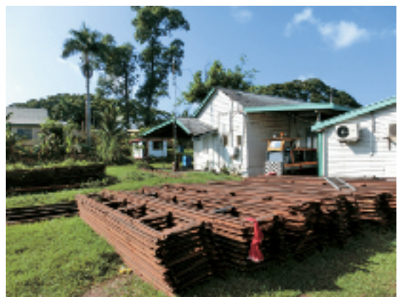
写真-38 FSCラウトカ工場の屋外には梯子のような農家用鋼製簡易軌道が積み上げられている。サトウキビ畑の中でこれをつないで収穫用のサトウキビ列車を走行させるのである。(2014年2月24日)
