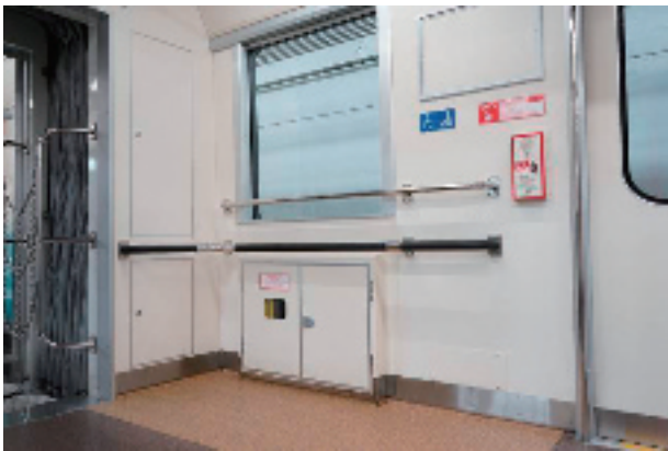
写真-4 車椅子スペースと非常梯子収納箱
