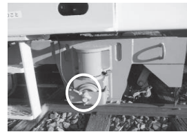
図10 車軸速度センサー
