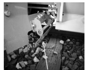
図13 軌間内散布超過検知棒
