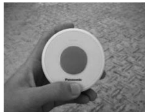
図17 遠隔操作用停止ボタン
