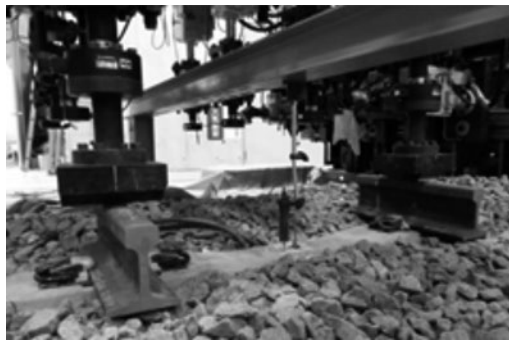
図19 繰り返し载荷試験
