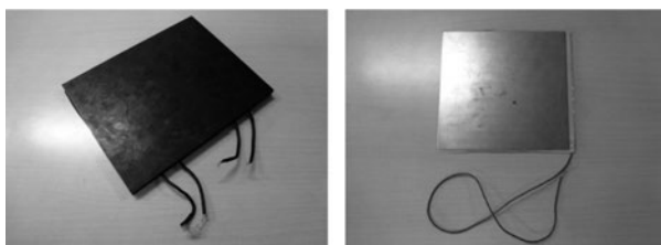
図14 圧力素子を用いたセンサ付軌道パッド
