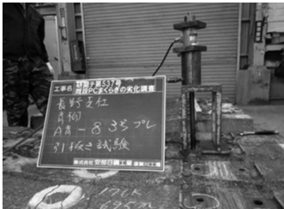
図2 埋込栓引抜強度試験方法
