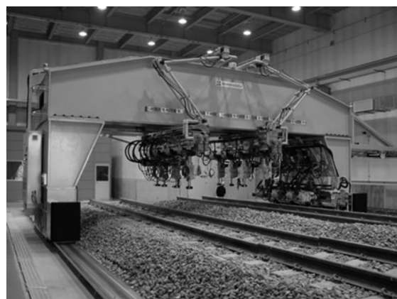
図18 実物大軌道試験装置
