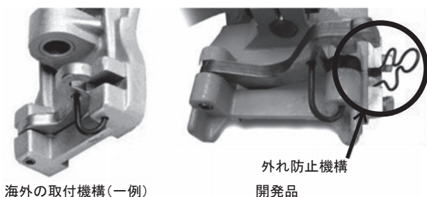
図2 ブレーキライニングの取付機構
