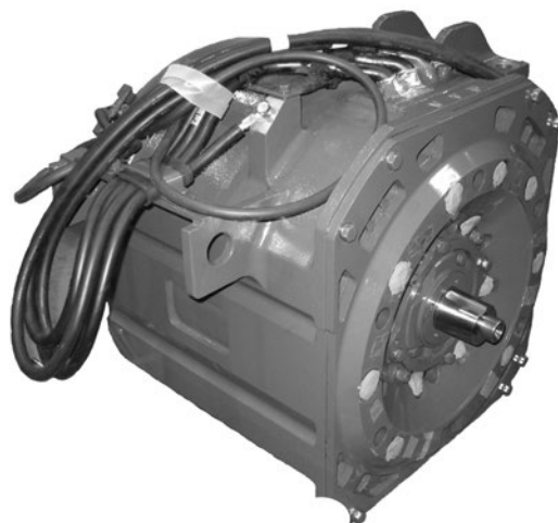
図1 開発した全閉式主電動機外観(駆動側)
