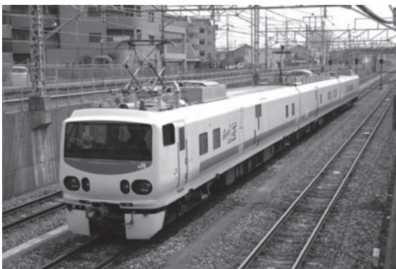
図1 在来線電気・軌道総合検測車 (East-i)
