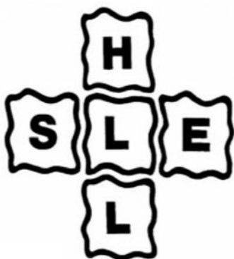
図1 SHELモデル。SはSoftware、HはHardware、EはEnvironment(環境)、Lはliveware(人間)を表す。
