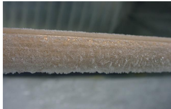
図 1 実験で再現された架線着霜の例
