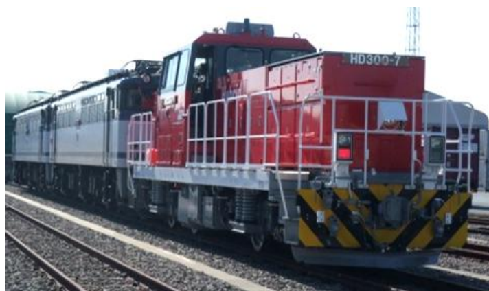
HD300 形式ハイブリッド入換機関車の走行試験
