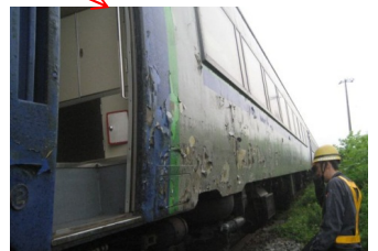
5号車 車体側面の塗装一部溶損
