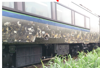
4号車 車体側面の塗装一部溶損
