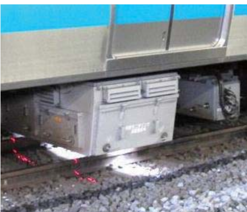
線路設備モニタリング装置
