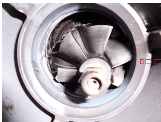
プロペラの破損状態
