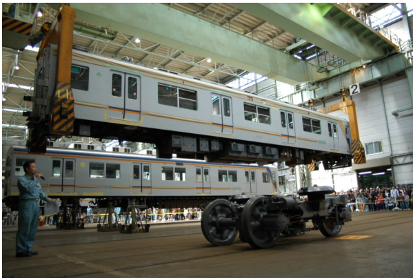
電車のクレーン吊上げ（イメージ）
