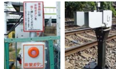
▲踏切支障報知装置
