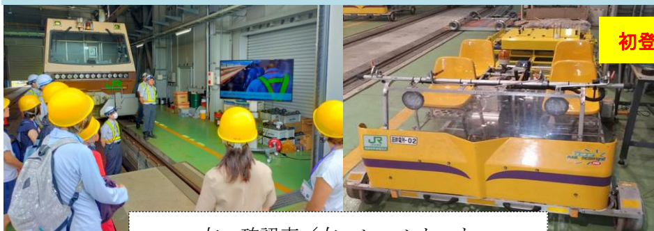
左：確認車／右：レールカート
