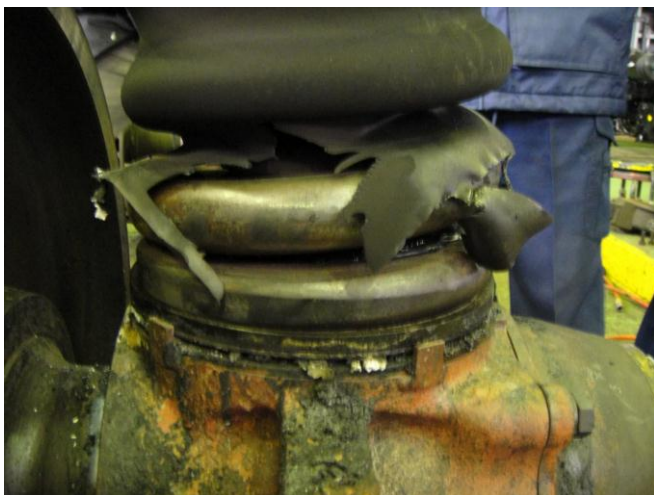
(写真2) 溶けた「軸バネ防雪ゴム カバー」
