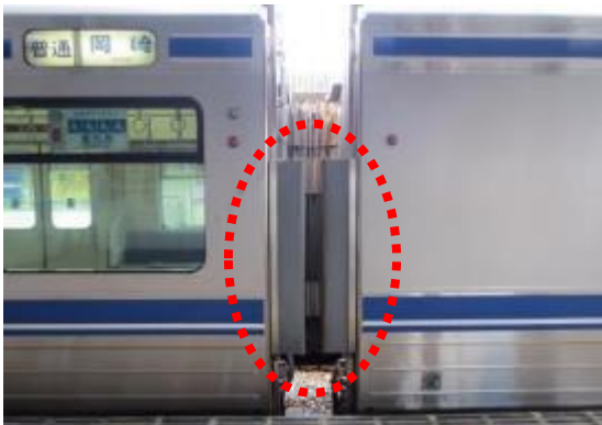
連結面部分に設置した転落防止用幌
