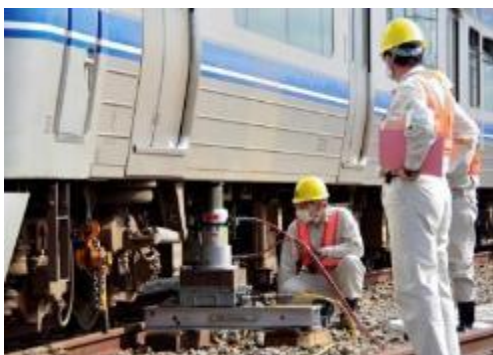
油圧ジャッキを使用した脱線車両の復旧訓練
