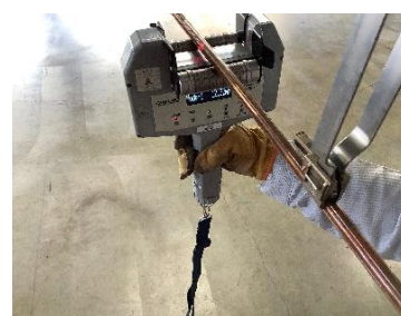
架線の検査機器
