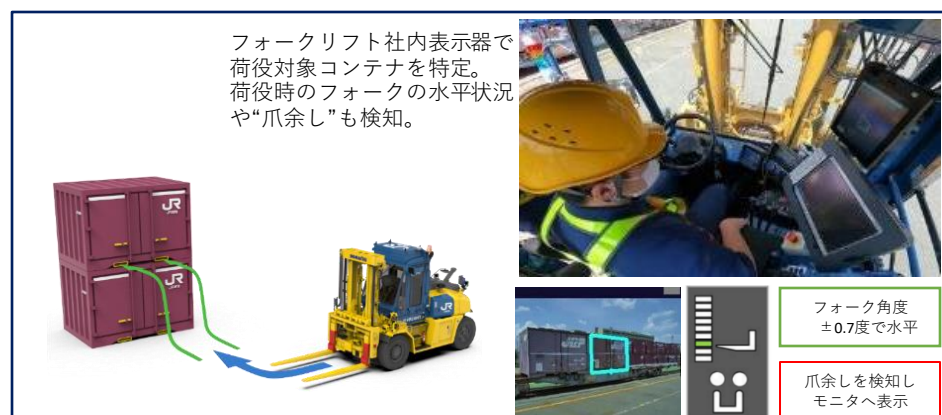
◆フォークリフト運転操作のガイダンス・セミオート機能のイメージ
