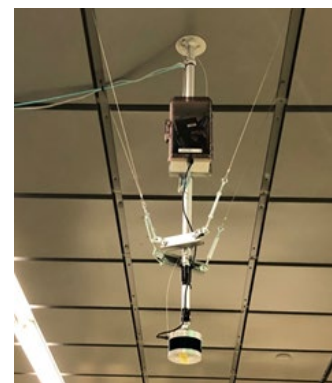
人流計測のための LiDAR
