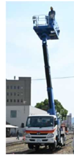
軌陸車（デモンストレーション）
