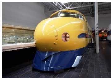
922形新幹線電気軌道総合試験車 （ドクターイエロー）
