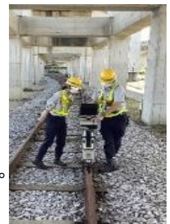
レール探傷検査
