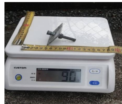
写真2 落下した金具
