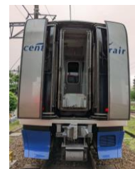
ミュースカイ全面扉開閉
