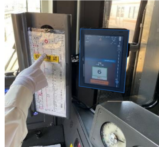
列車運転時刻表とCASTを運転台に設置し、列車を運転
