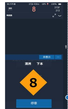
列車運転時刻表とCASTを運転台に設置し、列車を運転
