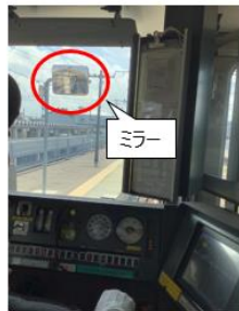
ホーム上のミラーによる安全確認
