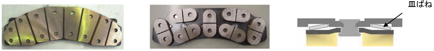
図1：ブレーキパッド（左：従来品、中央：開発品、右：開発品の断面模式図）
