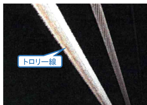
図2 架線着霜の例
