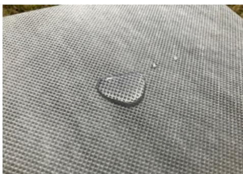
開発した吸音材表面（撥水イメージ）
